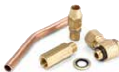
13 Doplnkový chladič, používa sa tam, kde je teplota vody pri vstupe viac ako 25°C alebo je prietok vody zo stroja menší ako 5 l/min.
